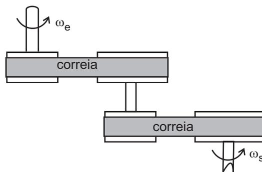
Desprezando-se qualquer perda de energia nesse sistema e admitindo-se que a correia seja inextensível, a razão entre os torques de entrada e de saída  $T_e/T_s$  é
