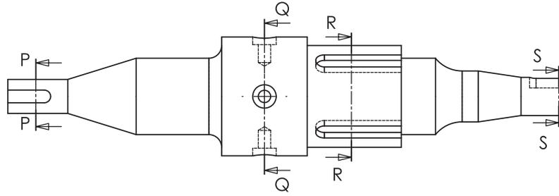
A Figura acima representa a vista frontal de um eixo cilíndrico no primeiro diedro. O eixo tem um rasgo de chave em cada extremidade, quatro furos cegos com rebaixo, iguais, na região de maior diâmetro, espaçados de 90° e quatro rasgos de chave na seção do segundo maior diâmetro, também iguais e espaçados de 90°.
