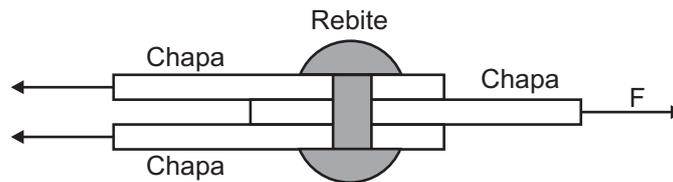
Se a força  $F$  é de 1,0 kN e a seção transversal do rebite é de 2,0 cm<sup>2</sup>, a tensão de corte atuante no rebite, em MPa, vale
