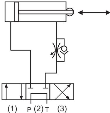
Esse controle é realizado pela válvula de controle de fluxo quando a haste se move para a
