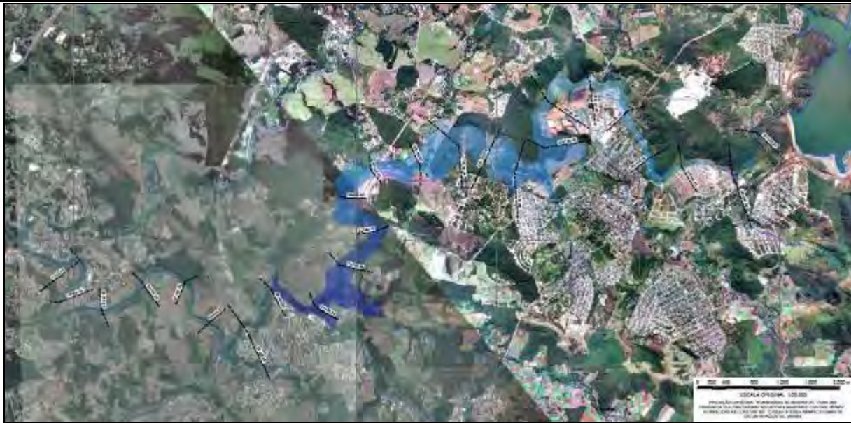
Figura 49: Mapeamento de áreas potencialmente inundáveis - Tempo: 1h e 33 minutos.
