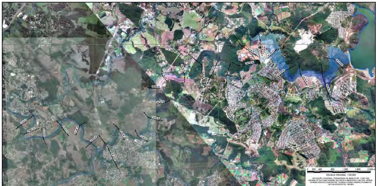
Figura 6.14: Mapeamento de áreas potencialmente inundáveis - Tempo: 20 minutos.
