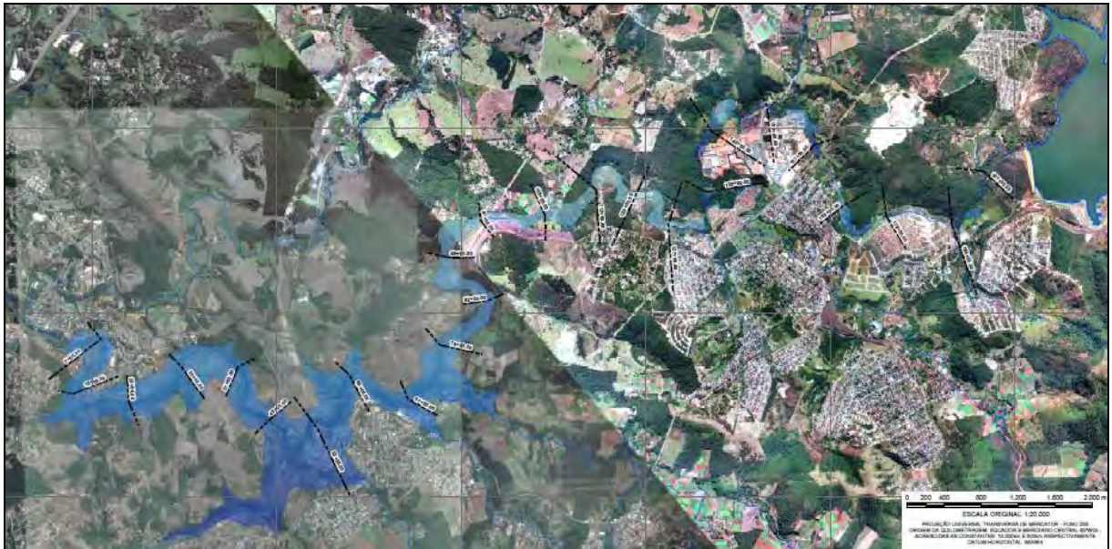
Figura 6.21: Mapeamento de áreas potencialmente inundáveis - Tempo: 4h e 32 minutos.
