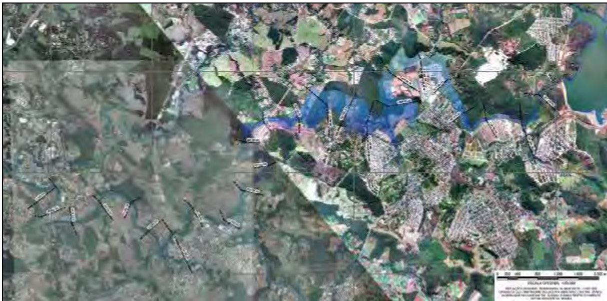
Figura 48: Mapeamento de áreas potencialmente inundáveis - Tempo: 1h e 01 minutos.
