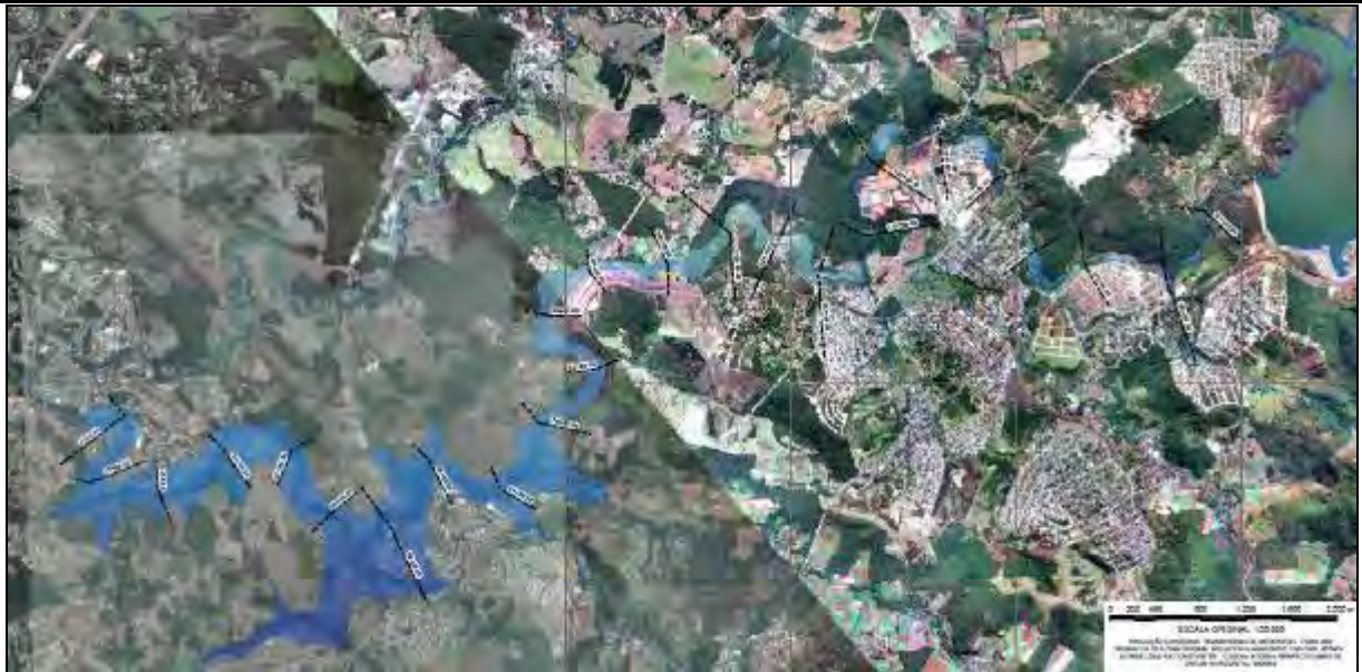
Figura 53: Mapeamento de áreas potencialmente inundáveis - Tempo: 4h e 32 minutos.
