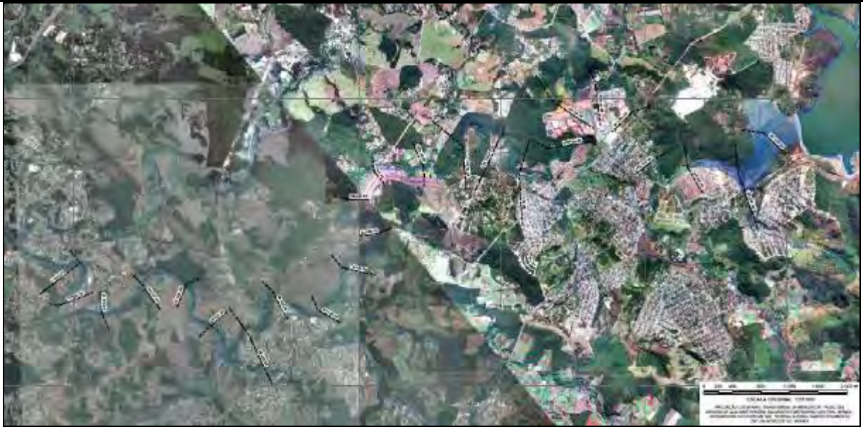
Figura 45: Mapeamento de áreas potencialmente inundáveis - Tempo: 6 minutos.
