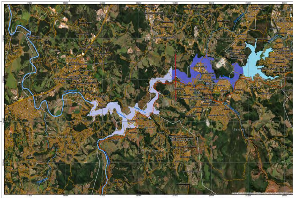
Figura 17 - Área de inundação modelada da ruptura da Barragem de Ibitité, com a ZAS grifada em azul mais escuro e a ZSS em azul mais claro.
