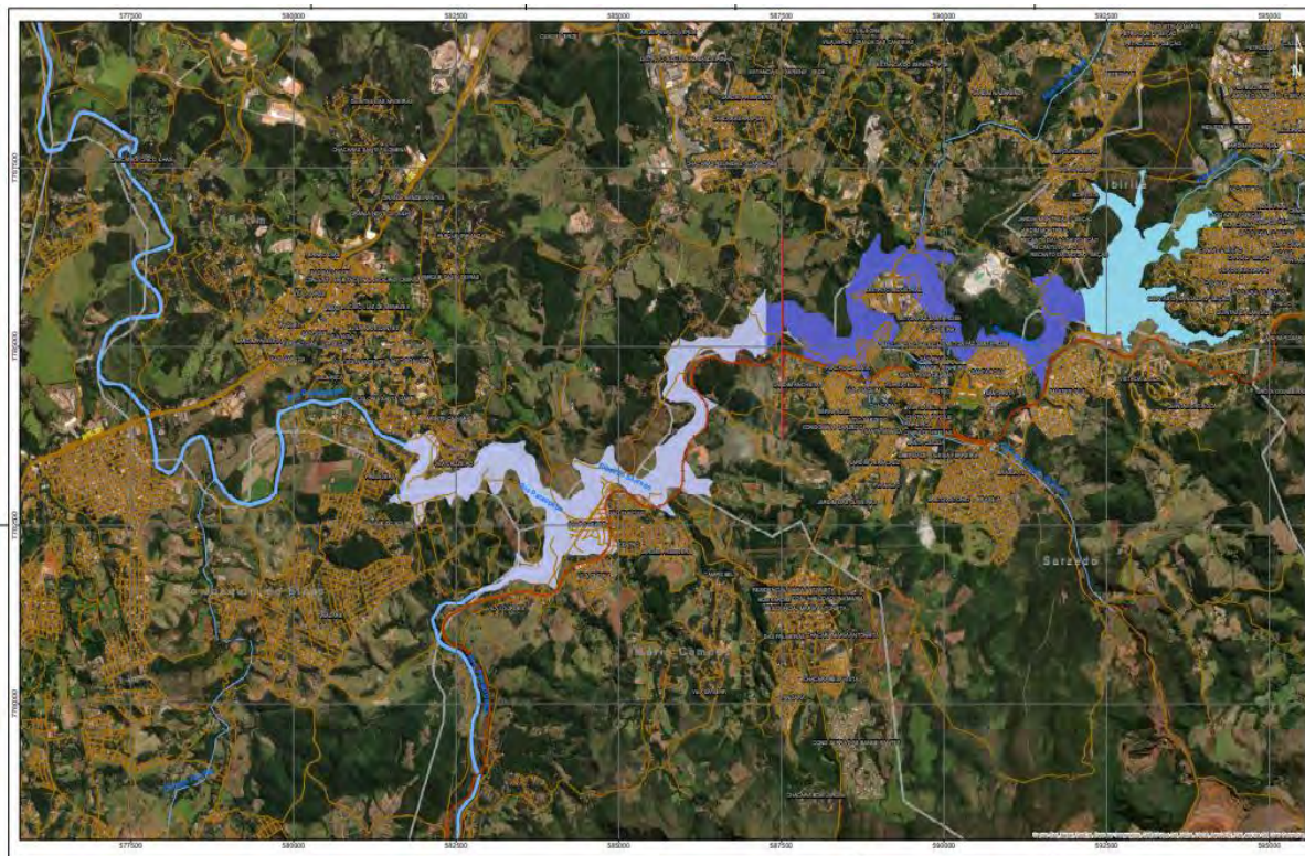
Figura 3: Área de inundação da ruptura da Barragem de Ibitaré.
