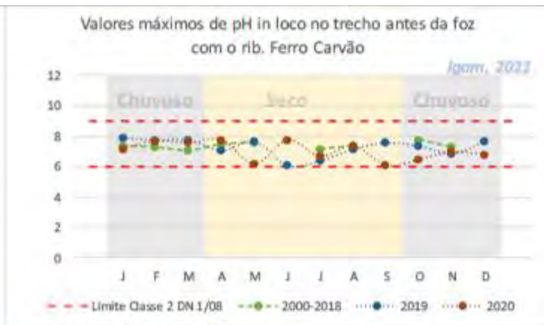
Gráfico 3 – Valores máximos mensais de pH, no período pré-rompimento e nos dois anos após o rompimento das barragens, no trecho antes da foz com o ribeirão Ferro-Carvão. Fonte: Elaborado pelo IGAM (2021)
