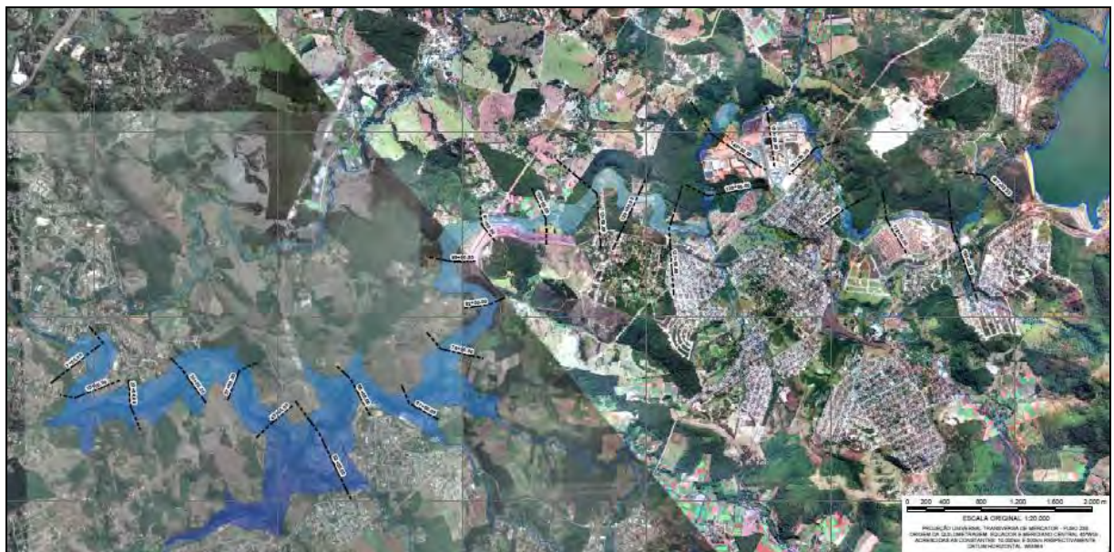
Figura 6.20: Mapeamento de áreas potencialmente inundáveis - Tempo: 4h e 08 minutos.
