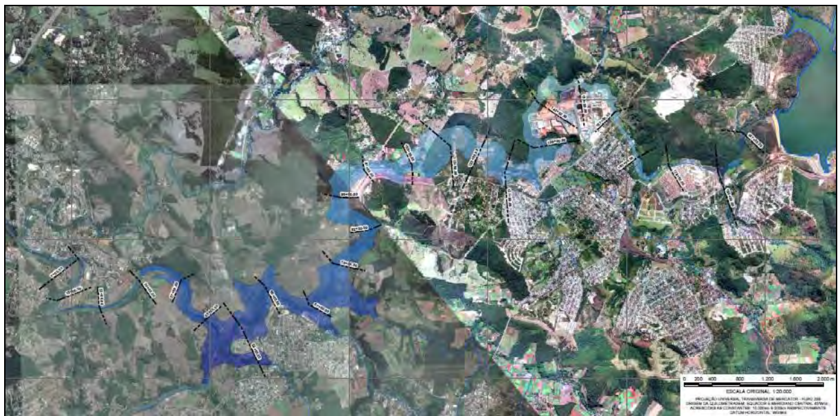
Figura 6.18: Mapeamento de áreas potencialmente inundáveis - Tempo: 2h e 06 minutos.
