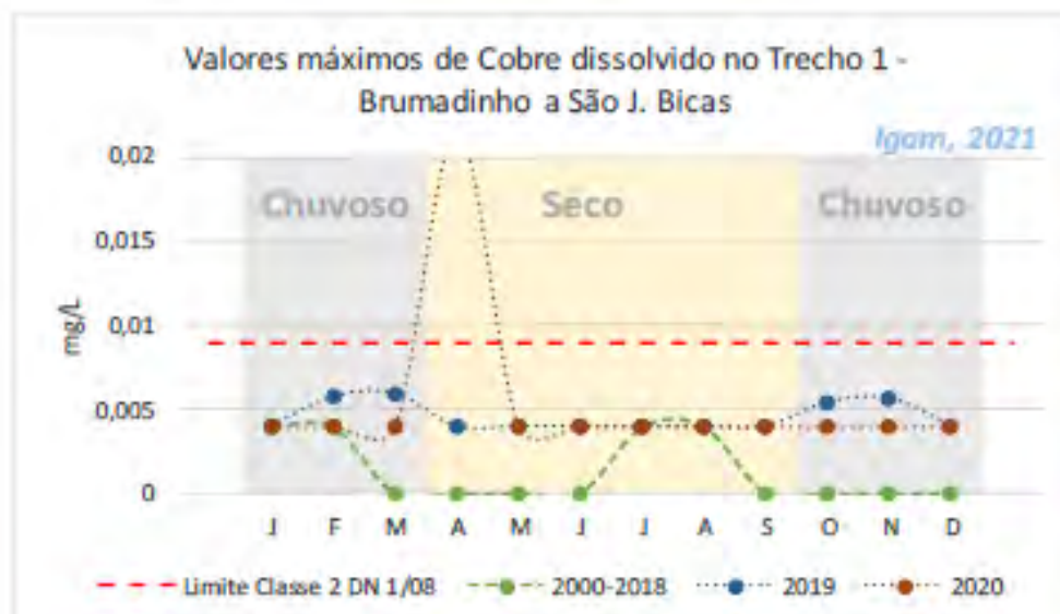
Gráfico 32 – Valores máximos mensais de cobre dissolvido, no período pré-rompimento e nos dois anos após o rompimento das barragens, no trecho 1, entre os municípios de Brumadinho e São João de Bicas. Fonte: Elaborado pelo IGAM (2021).
