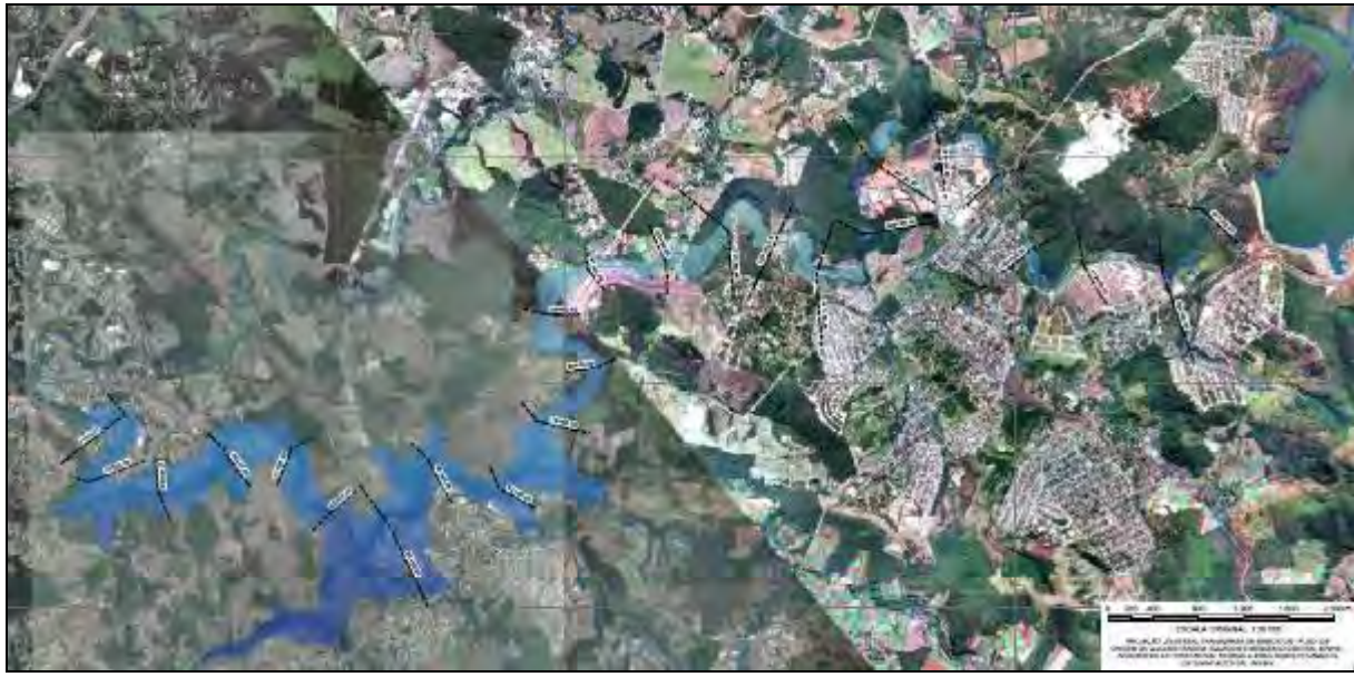
Figura 52: Mapeamento de áreas potencialmente inundáveis - Tempo: 4h e 08 minutos.
