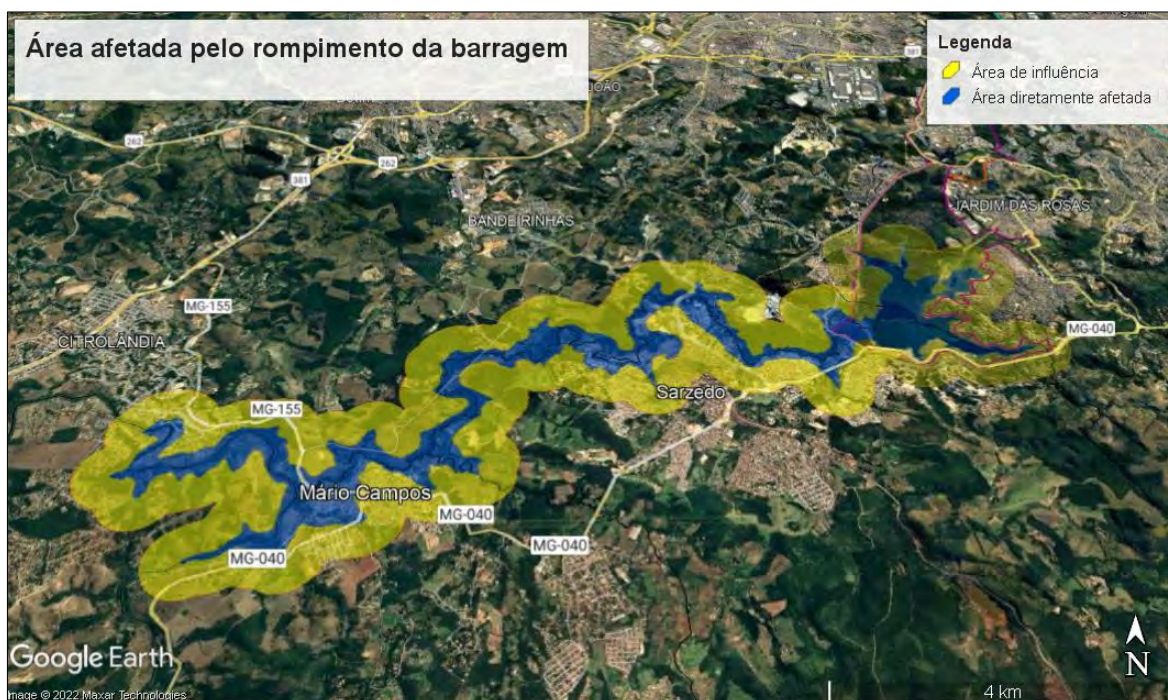
Figura II-1 – Simulação da área afetada pelo rompimento da barragem.
