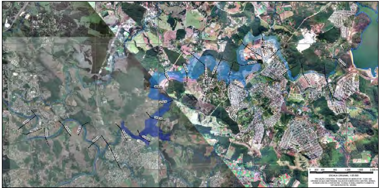
Figura 6.17: Mapeamento de áreas potencialmente inundáveis - Tempo: 1h e 33 minutos.
