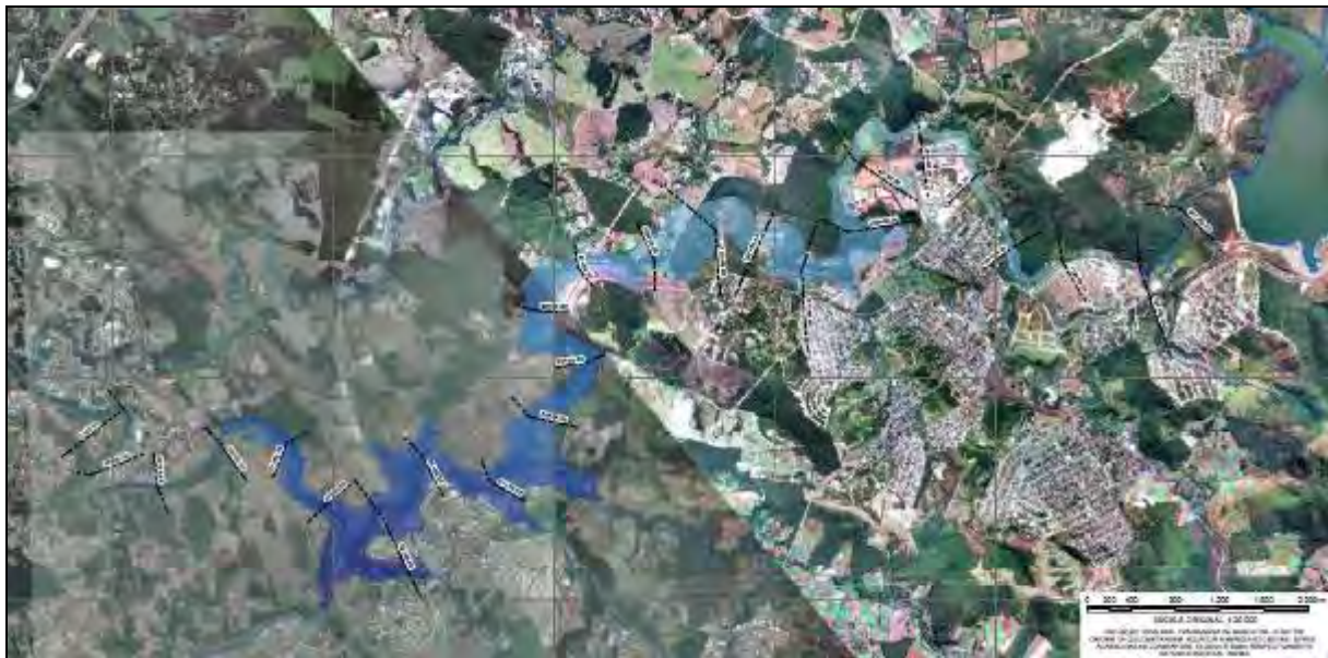
Figura 50: Mapeamento de áreas potencialmente inundáveis - Tempo: 2h e 06 minutos.
