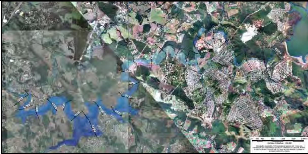
Figura 51: Mapeamento de áreas potencialmente inundáveis - Tempo: 3h e 07 minutos.
