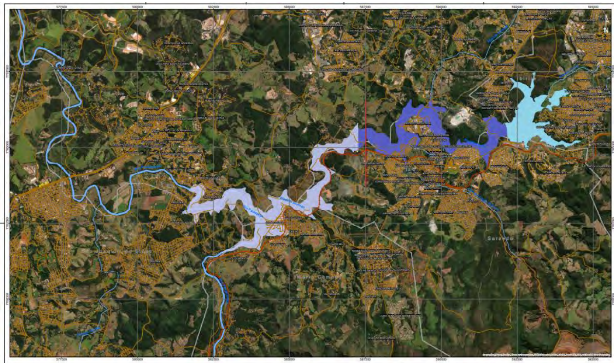
Figura 36 - Área de inundação da ruptura da Barragem de Ibitité modelada por PROJEL e que pode ser dividida em duas regiões: a de maior extensão, envolve o trecho de inundação dentro da Bacia hidrográfica do Ribeirão Sarzedo, e outra envolvendo o trecho do Rio Paraopeba a montante e a jusante da foz do Ribeirão Sarzedo.
