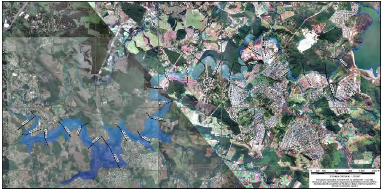
Figura 6.19: Mapeamento de áreas potencialmente inundáveis - Tempo: 3h e 07 minutos.
