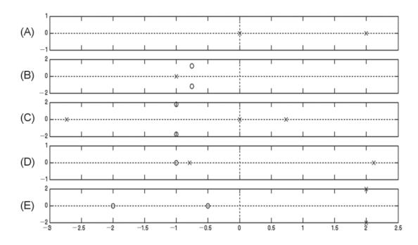
A Figura abaixo mostra um diagrama que representa o mapa de polos e zeros de um sistema discreto no tempo, com três polos (representados por "x") e dois zeros (representados por "o") em um período de amostragem unitário.
