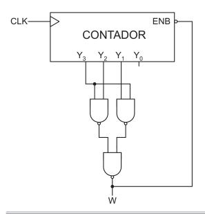
Considerando-se que o tanque está inicialmente vazio, e que o contador começa a sua operação com  $Y_3Y_2Y_1Y_0$  = 0000, quantos litros de combustível o tanque terá recebido quando a bomba interromper a sua operação?
