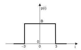
Uma corrente elétrica de natureza aleatória tem sua função densidade de probabilidade distribuída conforme mostrado no Gráfico acima, onde i é uma variável aleatória. Considere, nesse caso, que o valor eficaz ou r.m.s. do sinal de corrente é obtido pela expressão  $I_{ms} = \sqrt{E \lceil i^2 \rceil}$ , onde  $E[\cdot]$  representa o valor esperado ou expectância da variável aleatória.
