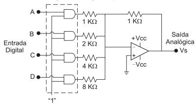
Sendo A o bit mais significativo e supondo-se ainda que os níveis lógicos assumam as tensões "1" = 5 volts e "0"=0 volts, quais são, respectivamente, a função das portas AND e a saída analógica Vs, em volts, para o binário de entrada composto dos bits A="1", B="0", C="0" e D="1"?
