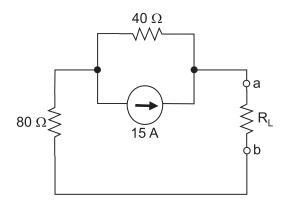
Considerando-se os valores mostrados no circuito, e com  $R_L$  = 80  $\Omega$ , qual a potência, em W, dissipada na carga resistiva?
