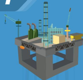
Inicialmente, se pensou em usar essa plataforma, uma TLWP. Ela trabalha apenas com poços concentrados sob ela, devido ao seu tipo de ancoragem. Junto com ela, trabalharia um navio para processar e armazenar a produção de óleo. Apesar de muito eficiente em poços bem profundos, estudos mostraram que montar o sistema assim seria mais caro que os demais e os resultados financeiros de 3 a 4 vezes menores que os apresentados para as soluções com FPSOs somente.
