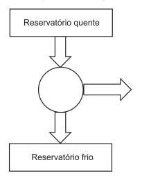
A cada ciclo, a máquina recebe 1000 W do reservatório quente e rejeita para o reservatório frio 300 W.
