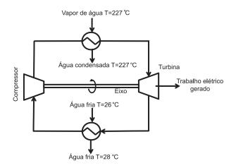
A Figura acima ilustra o processo de geração de energia elétrica contínua por um fluido de trabalho em fase gás. O fluido absorve calor de uma fonte quente que consiste em vapor de água que se condensa isotermicamente. Em seguida, o fluido movimenta as pás de uma turbina, gerando trabalho elétrico. O calor do fluido é, então, rejeitado para uma fonte fria, que consiste em água fria. Em seguida, o fluido é comprimido, completando o ciclo. O calor retirado da fonte quente é 2500 kW.
