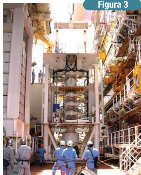
Sistema de segurança do poço (BOP)
